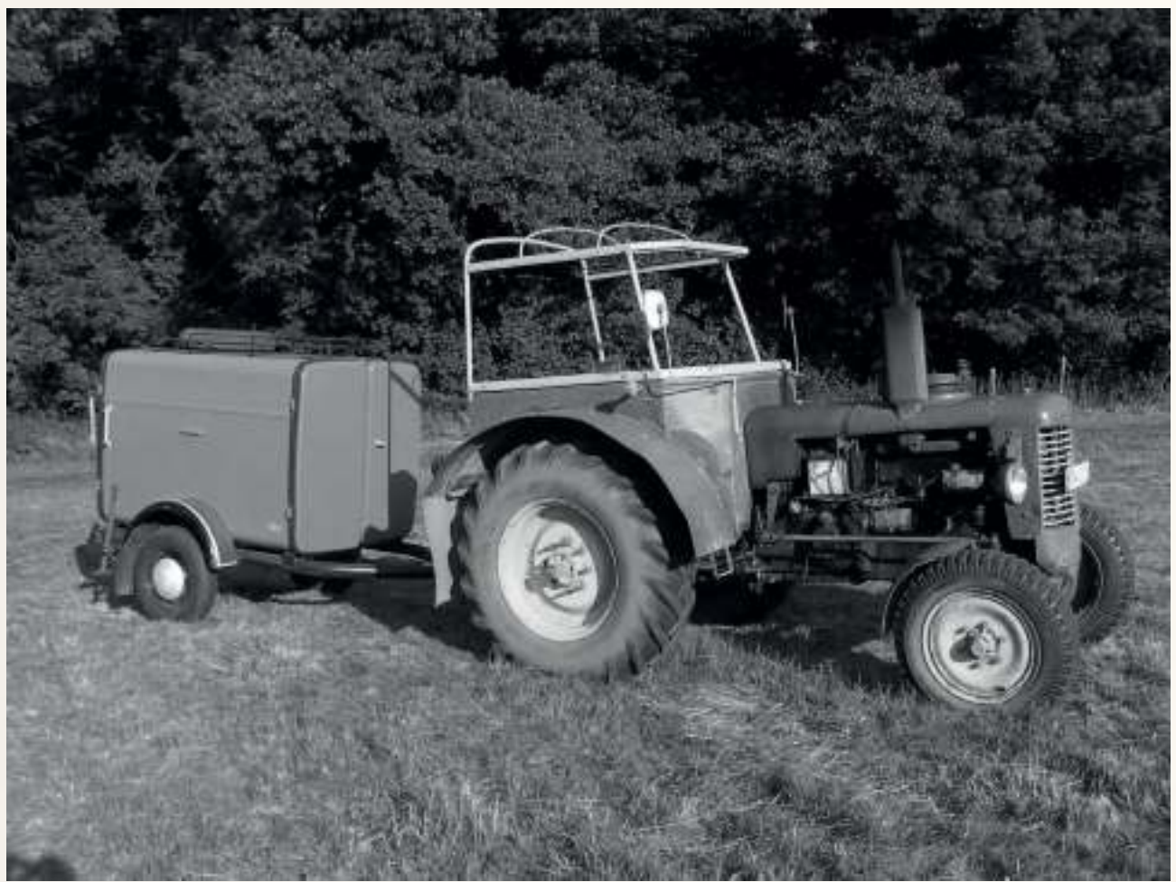
Traktor mit Tragkraftspritzen- anhänger (TSA), im Einsatz bis 1994
