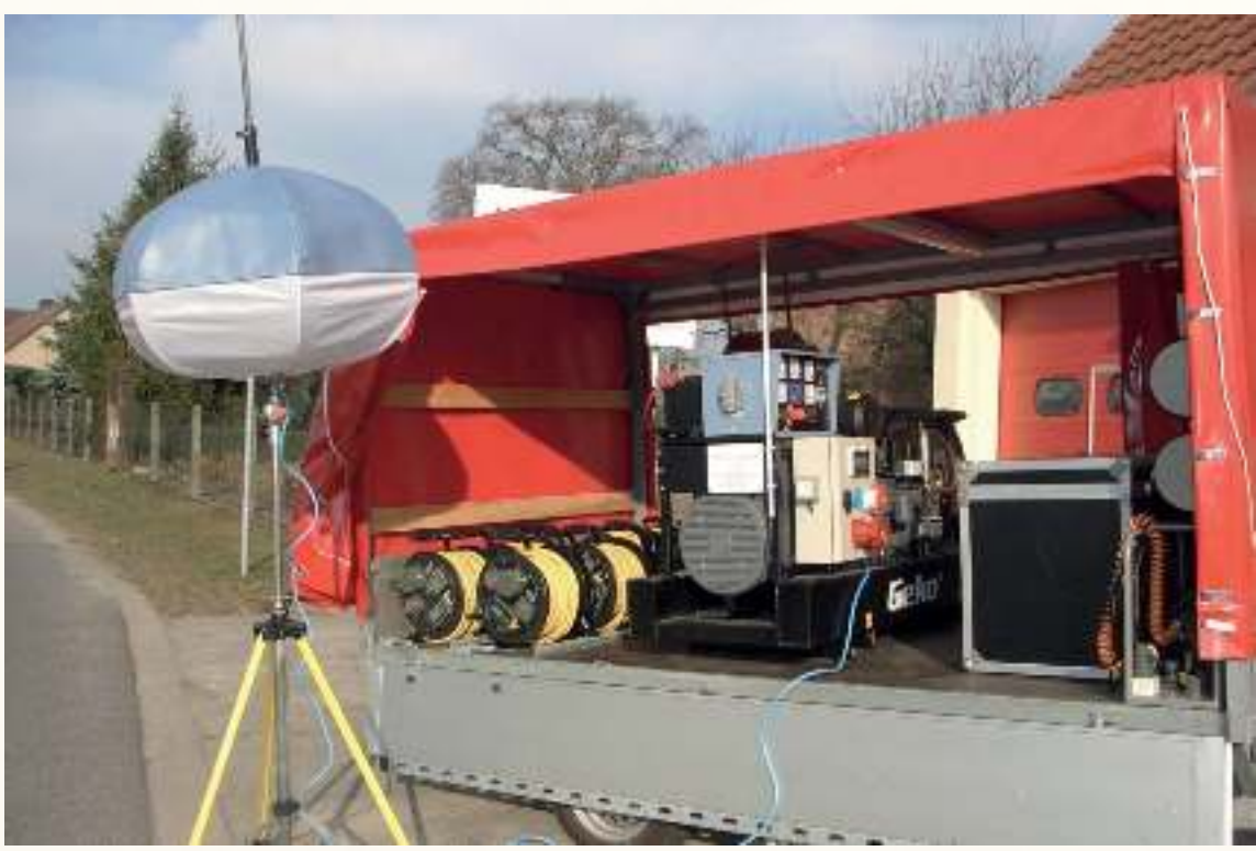
Beleuchtungsanhänger des Landkreises Spree-Neiße
